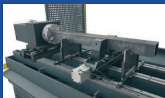
Rohrbearbeitung mit 4. Achse
