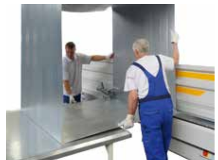
Verbesserte Falzqualität führt zu geringerer Verwindung des Kanalquerschnitts.
