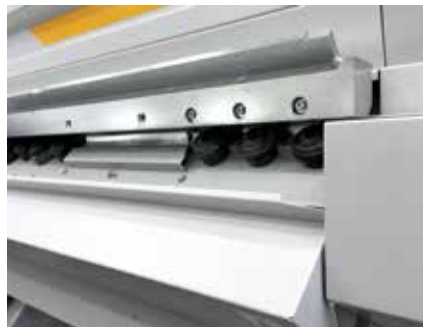
Für Wartungsarbeiten leicht zugängliche Umformrollen.
