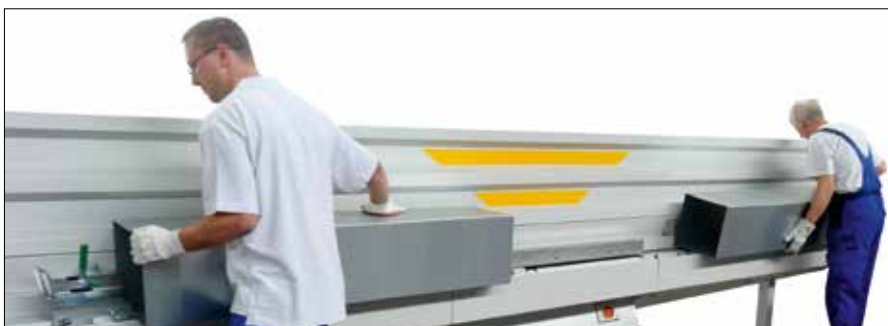
Für Wartungsarbeiten leicht zugängliche Umformrollen.
