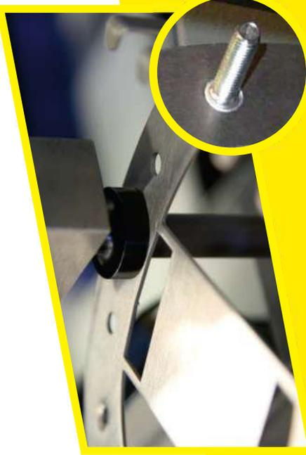
Problemloses **Einpressen** von verschiedenen Einpresserelementen mit einer Kraft von bis zu 16 to. Das heißt mit höherer Kapazität als bei herkömmlichen Einpressmaschinen.
