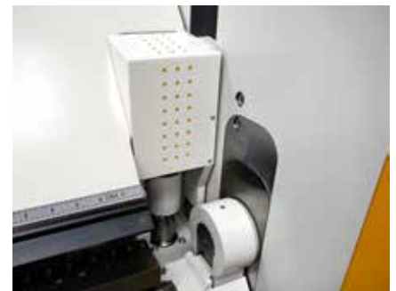
Die PowerBooster spannen die Bleche mit 120 Tonnen Spannkraft und sichern gerade Biegungen.
