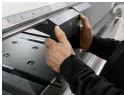
Schnelle Rüstvorgänge durch ein automatisches Spannen der Werkzeuge.
