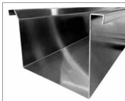
Hohe Werkzeuge für tiefe Gehäuse einsetzbar (500 mm Öffnungshöhe).
