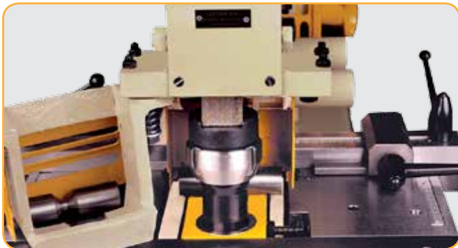
Übergroßbestanzeinrichtung bis zu \varnothing 36 \times 8 \text{ mm} in der Materialstärke.
