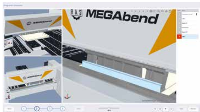
Eine 3D-Simulation zeigt den Biegeablauf, den Werkzeugaufbau und die Einlegesituation des Biegeteils.
