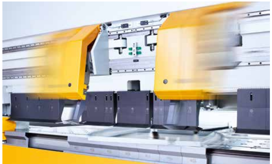
Vollautomatische Biegeabläufe: Positionieren, Drehen, Biegen und Werkzeugwechsel.
