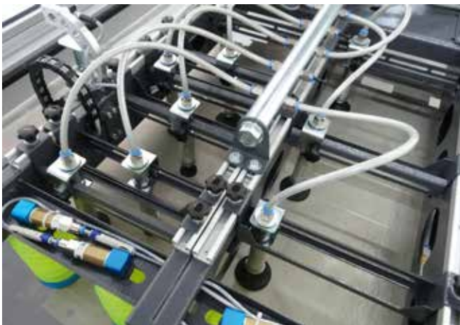
Saugrahmen der Portalbeladung mit 6 Vorsaugern und 45 frei positionierbaren Saugern.
