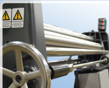
Konusbiegevorrichtung mit Diagonaleinstellung der Biegewalze, Gleitschuh und Handrad mit Register
