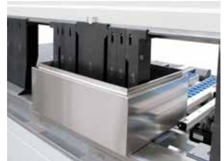
Oberwangenwerkzeuge für Boxen mit einer Höhe bis zu 400 mm.
