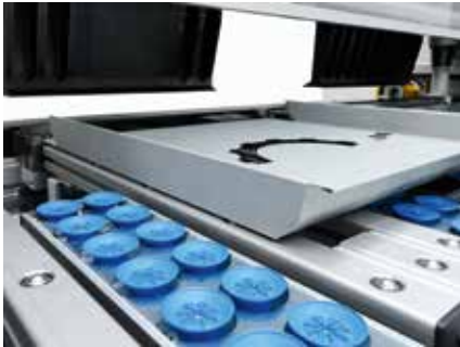
Automatisches Positionieren des Biegeteils durch den Saugeranschlag.
