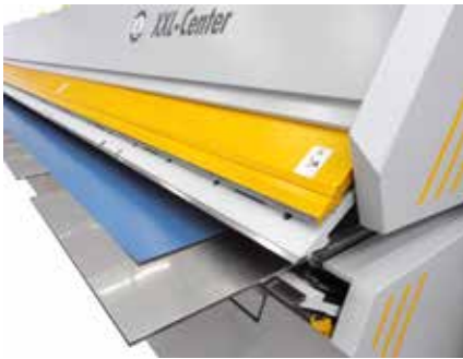
Einfaches Einlegen der Blechstreifen auf den herausgefahrenen Einlegetischen.
