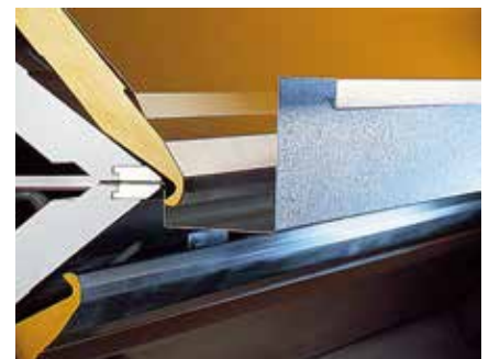
Kein Wenden der Biegeteile erforderlich, da die Maschine nach oben und unten biegt. Hohe Produktivität durch schnelle Biegeabläufe.
