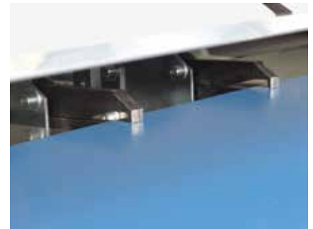
Greiferzangen positionieren das Biegeteil. Das sichert exakte Schenkelmaße und schnelle Biegeabläufe.
